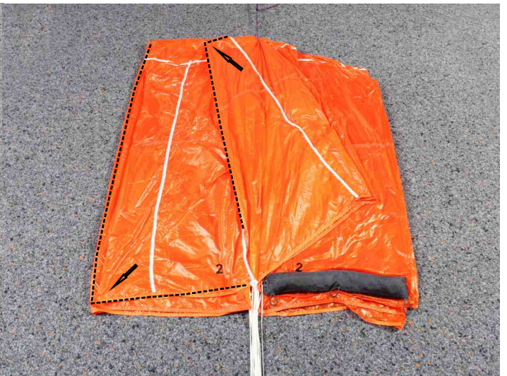
22. Bahn 2 legen und den oberen Teil der Bahn 1 seitlich herausziehen.
