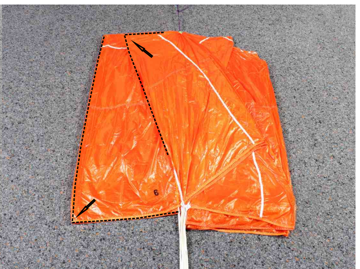
18. Bahn 6 legen und den oberen Teil der Bahn 5 seitlich herausziehen (Evo Cross 160: Bahn 7, oberer Teil der Bahn 6).
