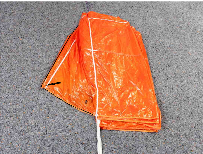
15. Bahn 9 (Evo Cross 160: Bahn 11) mittig zum Boden legen und die Bahn 8 (Evo Cross 160: Bahn 10) zur Seite rausziehen.
