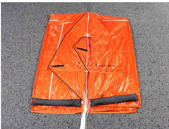
23. Bahn 1 legen (Eckbahn) und Basis mit Gewicht beschweren.
