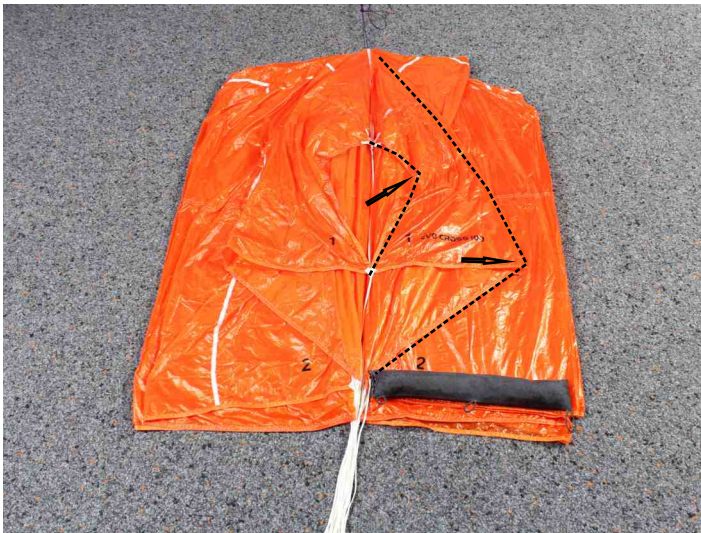
13. Bahn 1 legen (Eckbahn) und Basis mit Gewicht beschweren.
